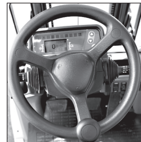
Полностью гидростатическое рулевое управление
