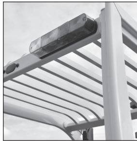
Конструкция верхнего ограждения не мешает обзору
