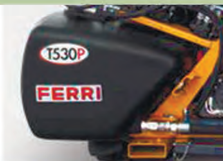
ГИДРОБАК ИЗ ПОЛИМЕРОВ LLDPE ДЛЯ ОБЛЕГЧЕНИЯ КОНСТРУКЦИИ
