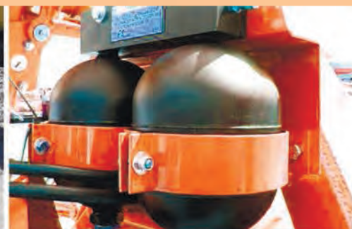
ОХЛАЖДЕНИЕ ГИДРАВЛИКИ, АЗОТНЫЙ АККУМУЛЯТОР
